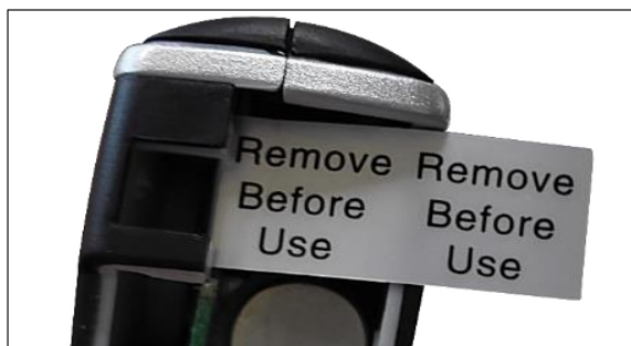
ИЗОЛЯТОР РАЗРЯДА БАТАРЕИ
